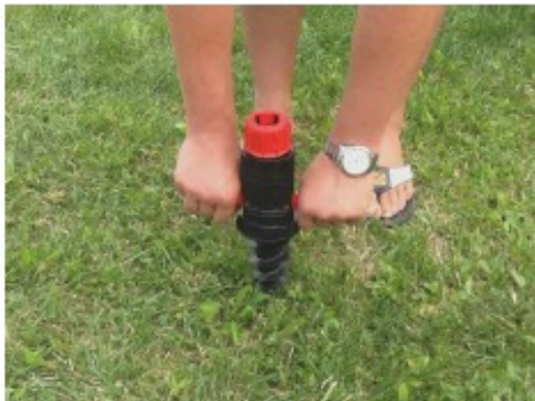
Nachystejte stojan dle druhu podloží a zajistěte svislou polohu
