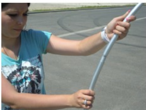
Spojte hliníkové trubky včetně oblouku na dorazy
